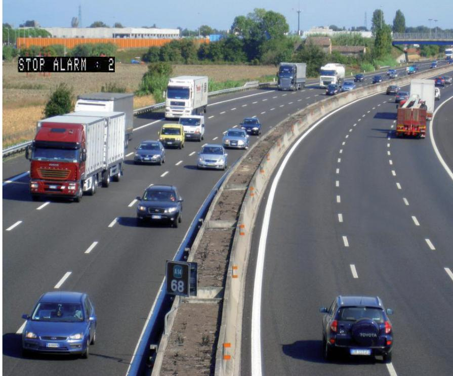
Il Controllo Intelligente del Traffico offre soluzioni A.I.D. (Automatic Incident Detection) per l'analisi del flusso veicolare in grado di processare in tempo reale eventi quali Veicolo fermo, Direzione inversa, Veicolo lento, Livello di traffico, Presenza Pedoni, Oggetti in carreggiata, Fumo, Conteggio e Classificazione veicoli attraverso analisi video.
